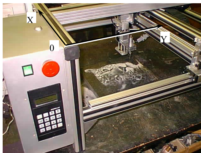
Рис. 2.2. Система координат компьютера и станка.
